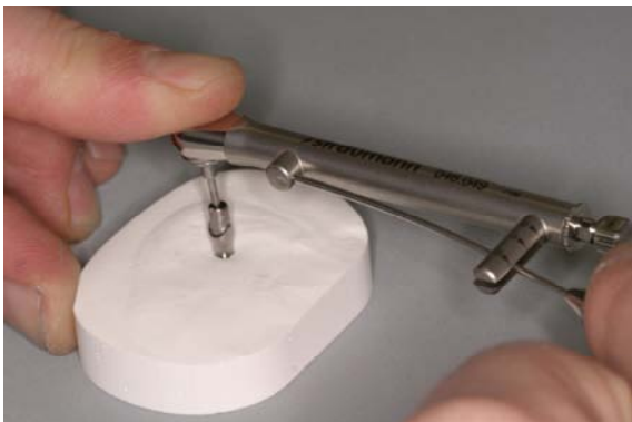
Abb. Vor dem Verkleben die Klebebasis mit 25 N/cm anziehen
